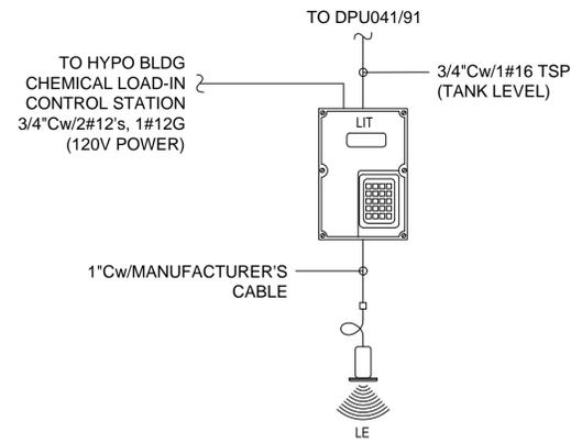
**SODIUM HYPOCHLORITE LEVEL TRANSMITTER WIRING SCHEMATIC**
